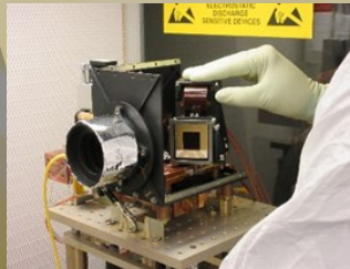
Intégration du détecteur VIS-NIR de MAJIS au laboratoire
