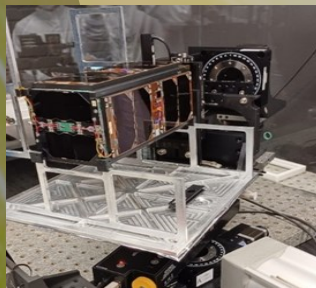
Le satellite INSPIRE-SAT 7 intégré sur son banc de test
